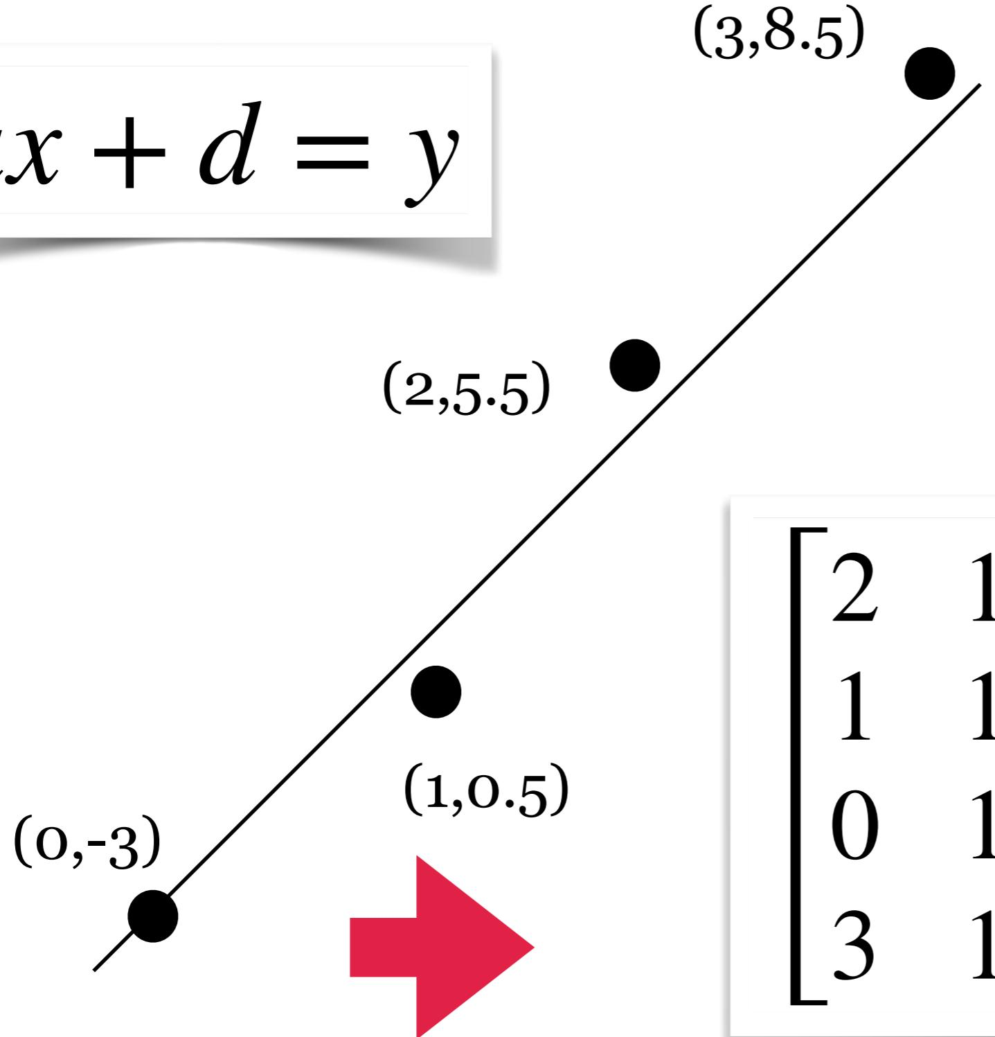
$$\begin{bmatrix} 2 & 1 \\ 1 & 1 \\ 0 & 1 \\ 3 & 1 \end{bmatrix} \begin{bmatrix} a \\ d \end{bmatrix} = \begin{bmatrix} 5.5 \\ 0.5 \\ -3 \\ 8.5 \end{bmatrix}$$
